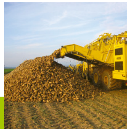
Les récolteuses modernes déposent les betteraves en bordure de champ.
