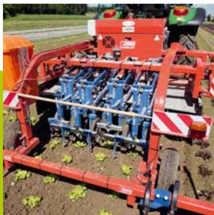
Lutte mécanique contre les mauvaises herbes à l'aide de bineuses.
