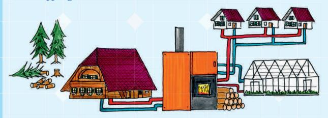
La chaleur produite par une chaudière à bois installée sur une exploitation agricole est acheminée par un réseau de conduites vers les différents utilisateurs sous forme d'eau surchauffée. Celle-ci est destinée à chauffer les habitations et l'eau sanitaire. Une fois sa chaleur transmise, cette eau retourne ensuite à l'installation thermique de la ferme et boucle ainsi son circuit.
