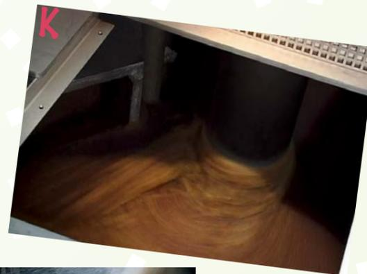
**11** Placés dans des centrifugeuses, les cristaux de sucre sont séparés du sirop. Une fois séché, le sucre est transporté dans les silos.
