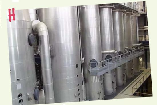
**8** Le jus vert contient encore de nombreuses impuretés. Du lait de chaux et du gaz carbonique sont ajoutés au jus vert. Ils lient les substances non désirables. Celles-ci se déposent au fond.
